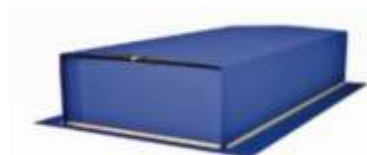
Použite plachtu alebo fóliu na prekrytie dosiek, aby voda nevtiekala do vnútra.
